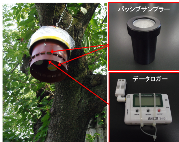
図 3 パッシブサンプラー、データロガーの設置状況
