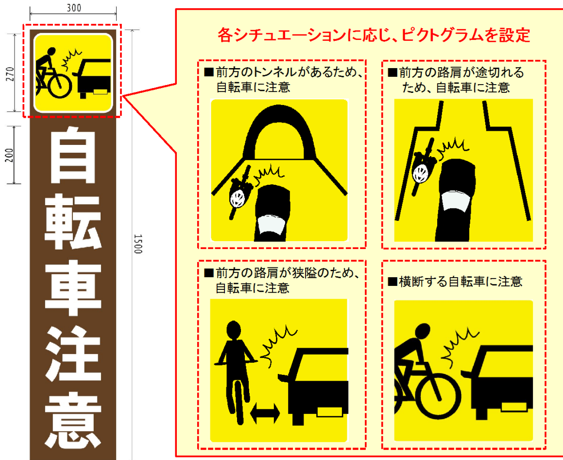
図- 4.17 自動車用の注意喚起法定外標識
