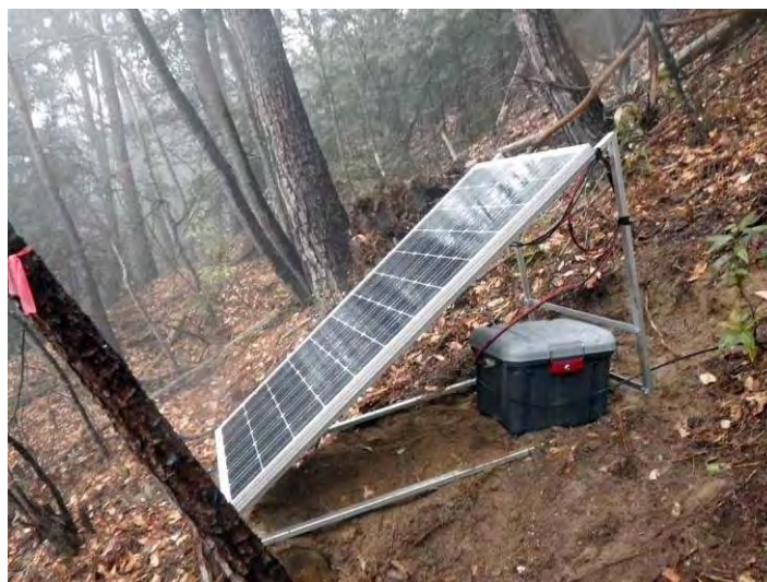
図 30.2.53 システム電源（ソーラーパネル）とデータ送信機の設置状況 (平成 27 年 1 月 15 日撮影)
