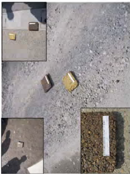
様々な場所に舗装サンプルを置き、 周囲と調和する舗装材を検討
