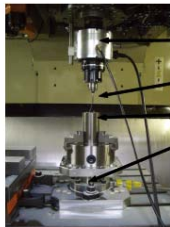
●超音波ねじり振動を援用したタップ加工
