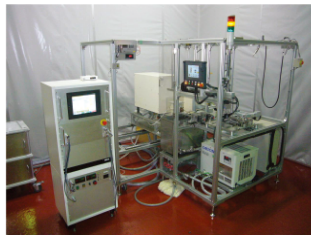
● 試作した熱処理装置
