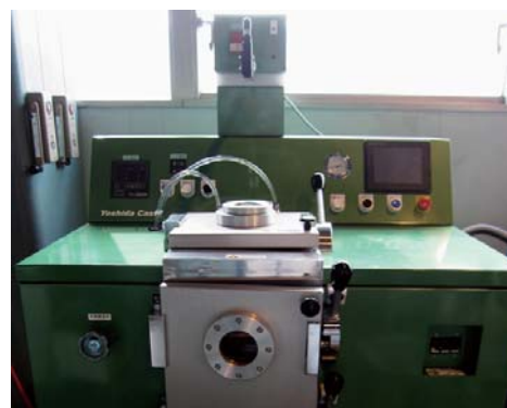
研究で使用している真空铸造機
