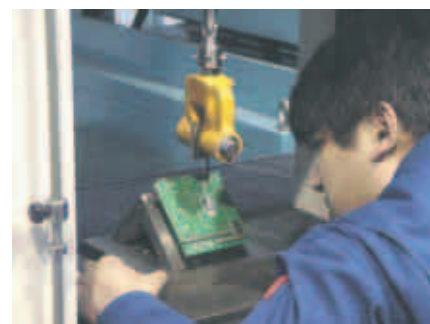
鉛フリーはんだ接合部の評価試験（引っ張り試験）
