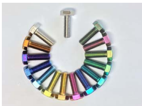
図1 熱処理により様々な発色した六角ボルト (上部は処理前、外周は処理後)
