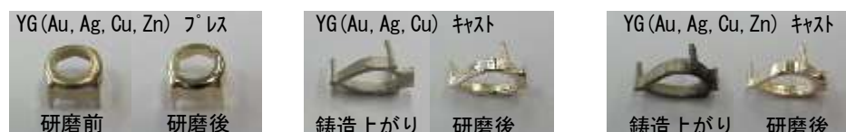
図2 複雑形状試料の研磨
