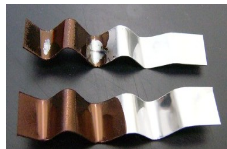
図1 直流電圧で成膜した試料（上） および交流電圧で成膜した試料（下）
