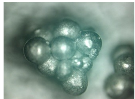
図1 粒子同士が密着した様子 (Sn めっき)
