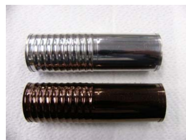
図 3 成膜前（上）とポリアニリン成膜後（下）の鉄素材
