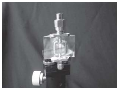
図4 コブレナ線路状の電極を有する光電界センサの写真
