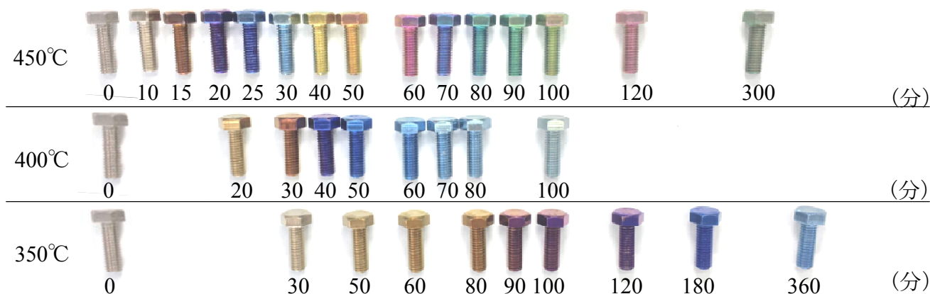
図2 熱処理温度と処理時間による色調の変化(六角ボルト)
