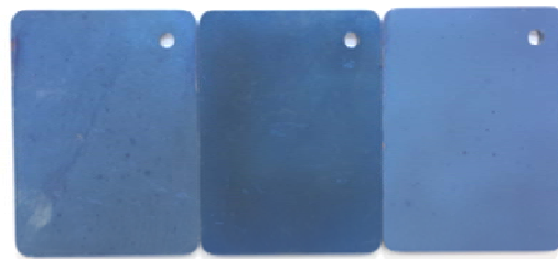
溶剤脱脂のみ 表面研磨 サンドブラスト
