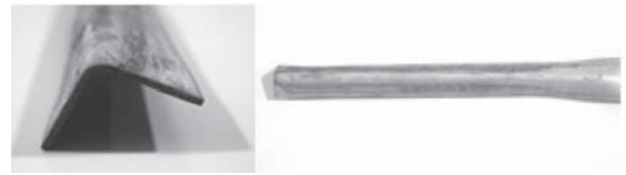
図 4 簡易的な装置による連続曲げ試験結果
