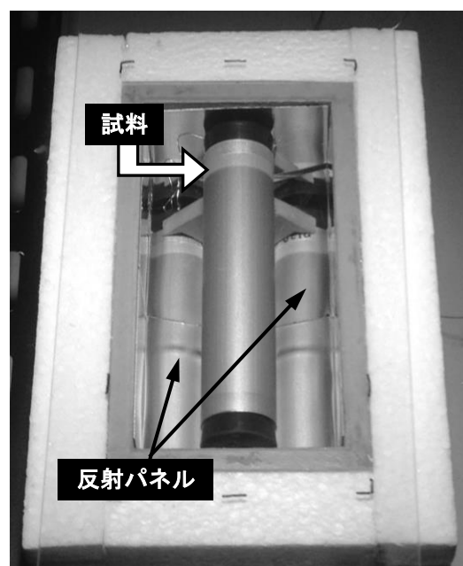
図1 光照射に伴う試料内部の温度変化を測定するための評価容器
