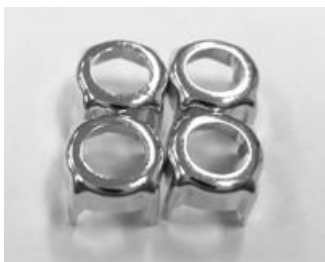
図5 複数試料の研磨
