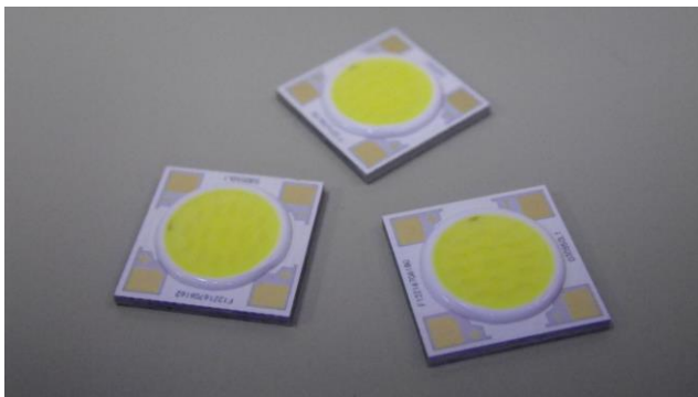
図2 加速試験に使用した COB 型 LED
