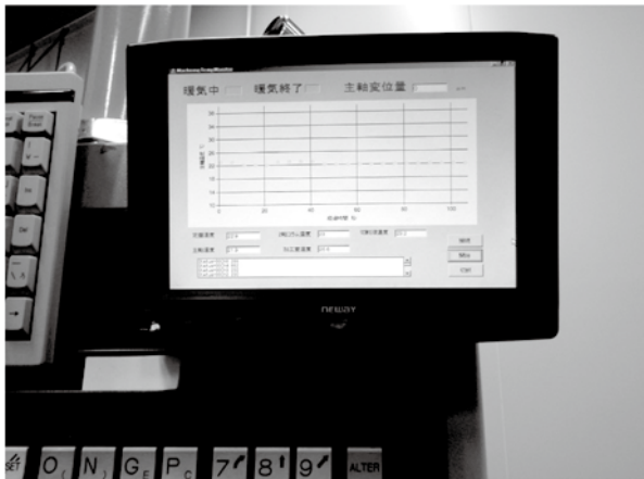
図5 マシニングセンタ操作盤への設置状況
