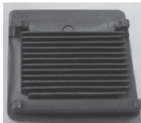
図12 プラズマ窒化した A2014 材ヒートシンク
