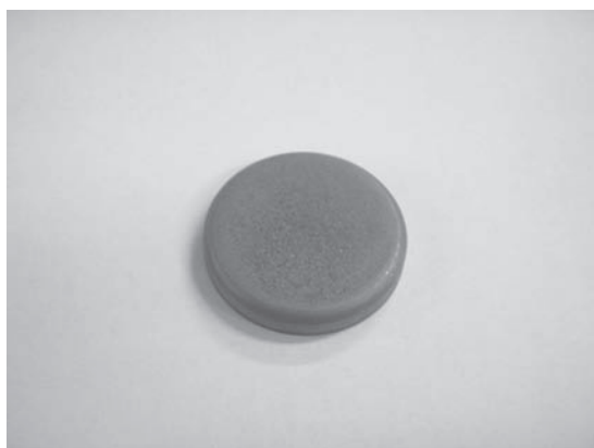
図9 プラズマ窒化した A2011 材部品
