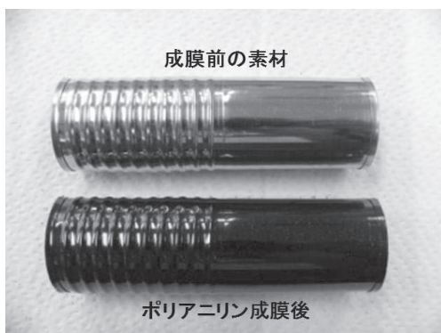
図 12 筒形状素材へのポリアニリンの成膜
