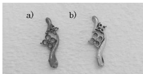
図2 電解研磨後のK10WG鋳造品
