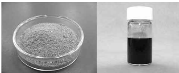
図3 ポリアニリン／ポリスチレンブレンド樹脂（左）、ポリアニリン／ポリスチレン溶液（右）
