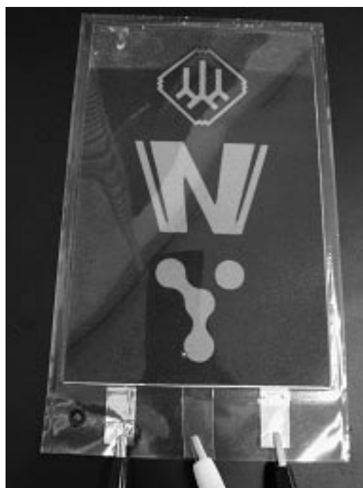
図8 試作したPEN基板上膜を使用した表示装置
