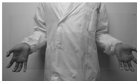
図 11 2号機で成膜した GZO 膜 (基板サイズ: 650mm × 300mm)
