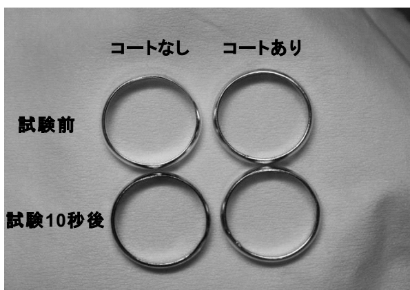
図 1 耐硫化性試験結果(浸せき時間：10 秒間)
