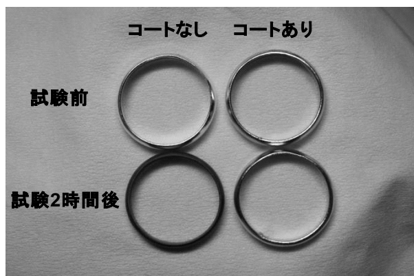
図 2 耐硫化性試験結果(浸せき時間：2 時間)
