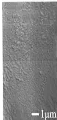
図11 微小穴の側面 (加工面) の電子顕微鏡観察写真
