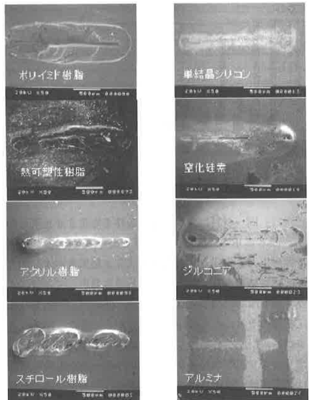
図3 樹脂材料・硬脆材料へのレーザー加工状態 (加工条件: 2.2 [kW], 10 [kHz])
