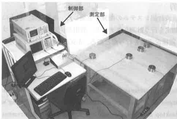
図2 卓上型妨害電磁波計測システム外観
