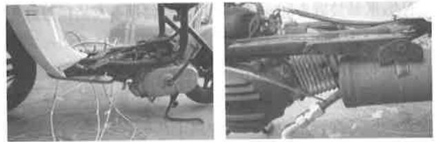
図2 排気ガス温度測定箇所 (5か所)
