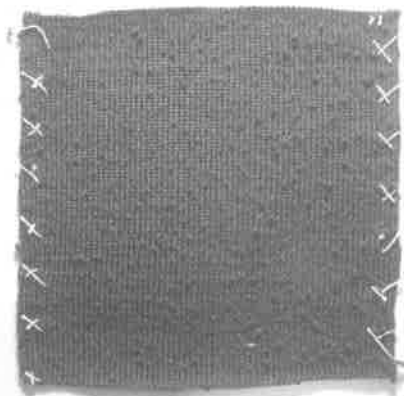
(c) 条件 [1.0%, 60°C, 3時間] で処理した編地
