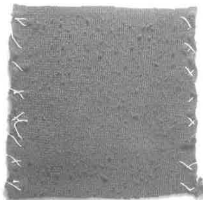
(d) 条件 [0.5%, 60°C, 4時間] で処理した編地
