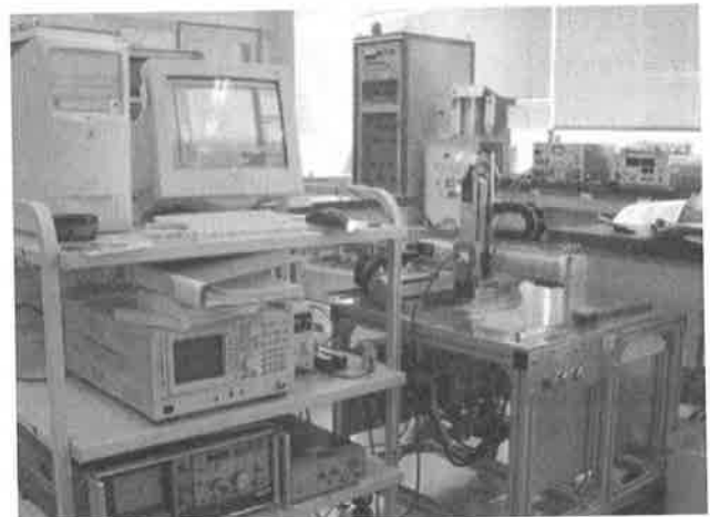
図1 試作したハンダ接合部の断面形状測定装置
