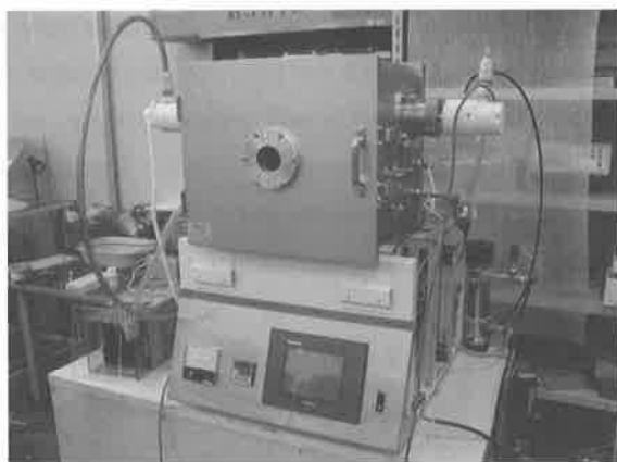
図3 沿面プラズマオゾン滅菌装置2号機の全体概要
