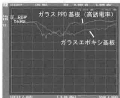
図9 伝送利得(S21)測定値 ガラスエポキシ基板とガラスPPO基板(高 \epsilon )の比較
