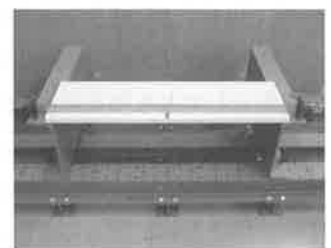
写真40 棚板のたわみの試験 写真41 棚板の初期たわみの測定
