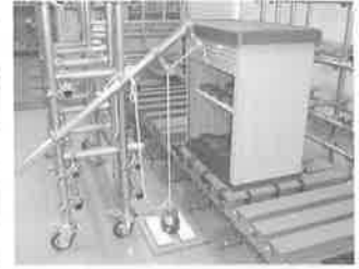
写真50 上下巻戸の急速開閉試験（開方向）
