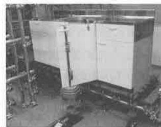
写真46 開き戸の強度試験（垂直力試験）
