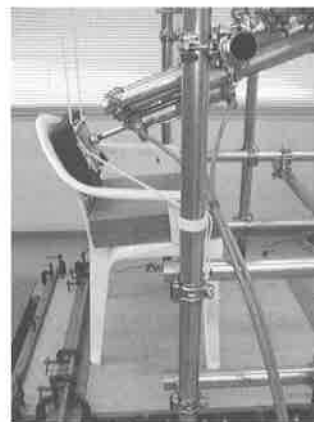
写真68 座面の耐久性試験 写真69 座面の耐久性試験
