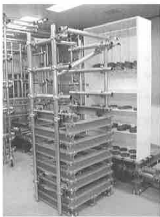
写真42 ハンガー用レールのたわみ試験
