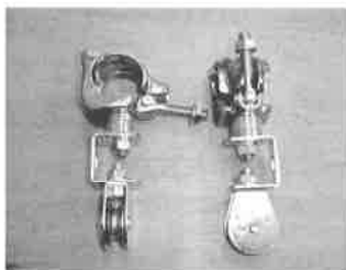
写真32 引違い戸の急速開閉試験用滑車
