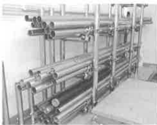
写真3 仮設資材の単管
