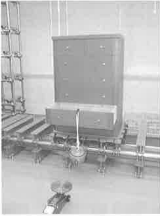
写真52 引出し及びランナー 写真53 引出しの急速開閉試験の強度試験
