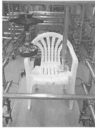
写真66 ひじ部の静的水平力試験 写真67 ひじ部の静的垂直力試験
