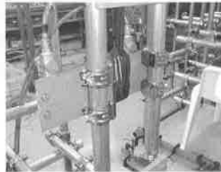
写真25 エアシリンダーの取り付け方法
