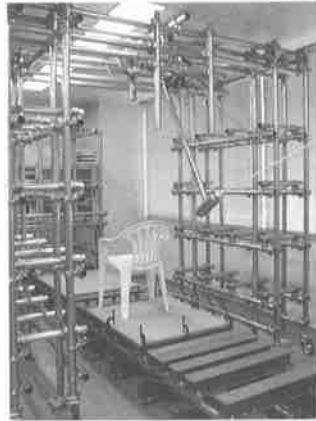
写真73 背もたれの耐衝撃性試験
