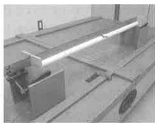
写真43 ハンガー用レールの初期たわみの測定
