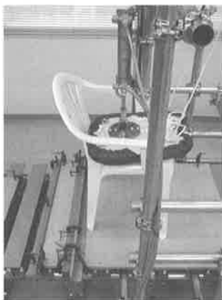
写真68 座面の耐久性試験 写真69 座面の耐久性試験
