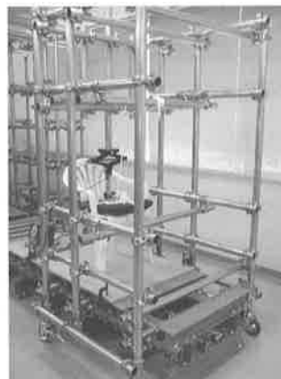
写真64 座面の静的強度試験 写真65 背もたれの静的強度試験
