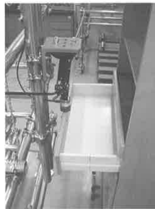
写真57 垂直力による安定性試験（引出し） 写真58 垂直力による安定性試験（伸縮板）
