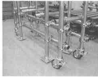
写真17 中央タワー足下のキャスターと高さ調整脚
