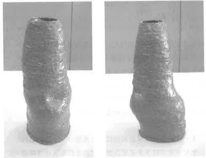
図4 熱溶解積層造形により製作した義肢ソケット 写真左側：正面 写真右側：側面
