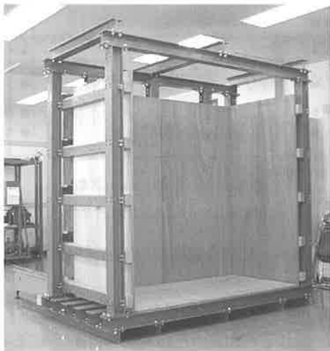
写真3 壁取付具の強度試験装置（正面斜め方向）
