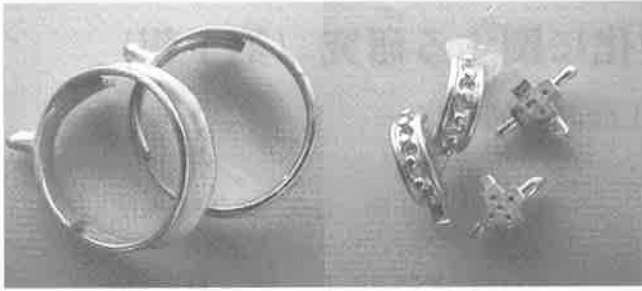
図10 使用済み埋没材を使用して鑄造した製品
