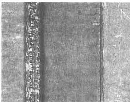
図6 銀 (Ag925) 同種素材の溶接 接合速度, 75mm/min Mag.50
