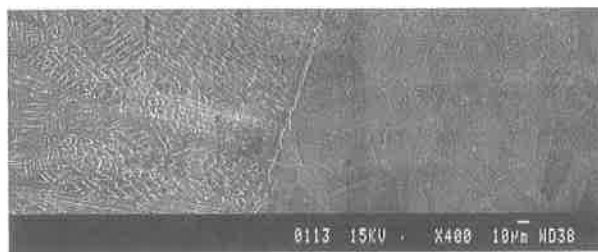
TIG 溶接, 溶接速度：150mm/min, 溶接電流：16A
