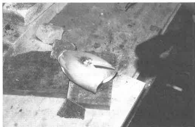
写真2 鑢付け作業中の貴金属
