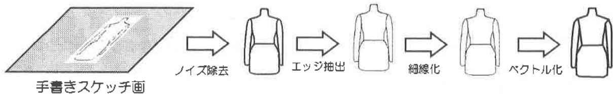
図2 スケッチ画像からベクトル化を行う際の手順
