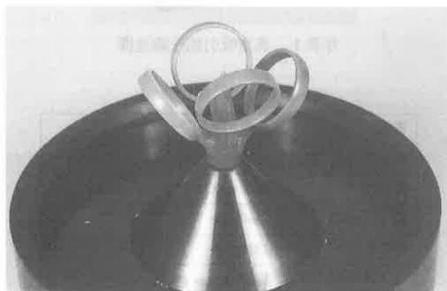
写真2 鋳造に使用したワックスツリー
