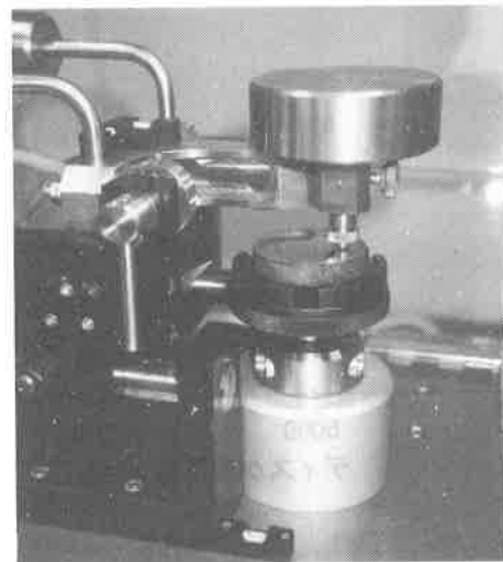
写真3 ball on disk式摩耗試験機
