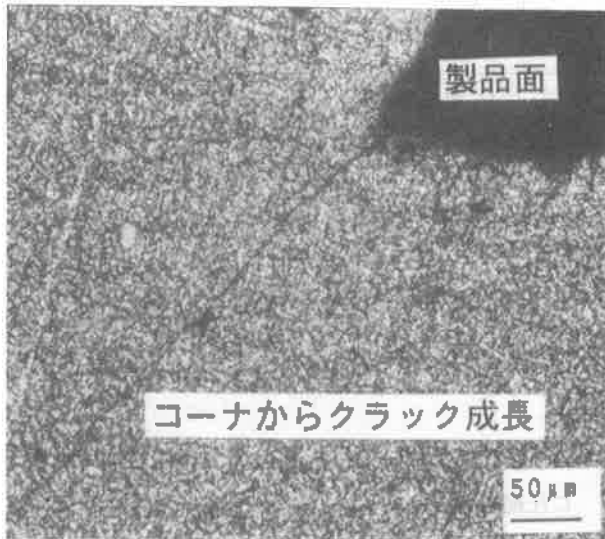
図7 図6の解析結果に対応したダイカスト金型の欠陥発生部の顕微鏡写真
