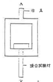
図2 試験材の引張試験方法
