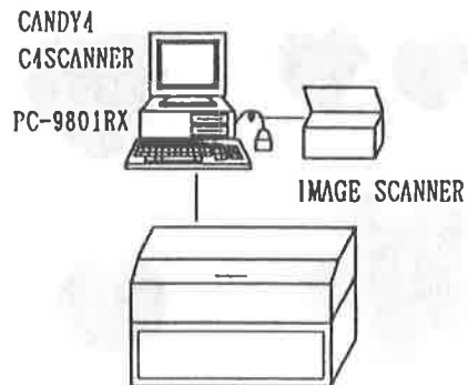
図2 変形状研削機の構成図
