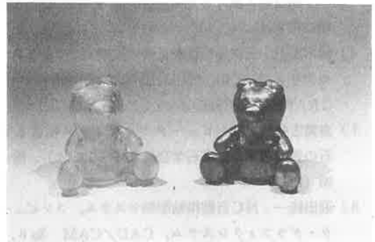
写真5 樹脂モデルと casting で得られた金属型
