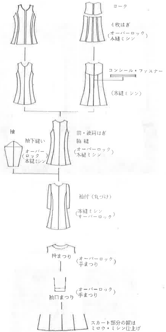
図4 プリンセスライン・ワンピースの工程 (写真11・12)
