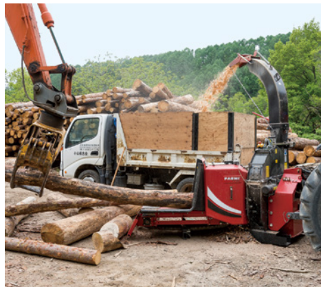
伐採された松枯れ材は、移動式チップパー機によりチップ化され、ゴルフ場へ搬出される
